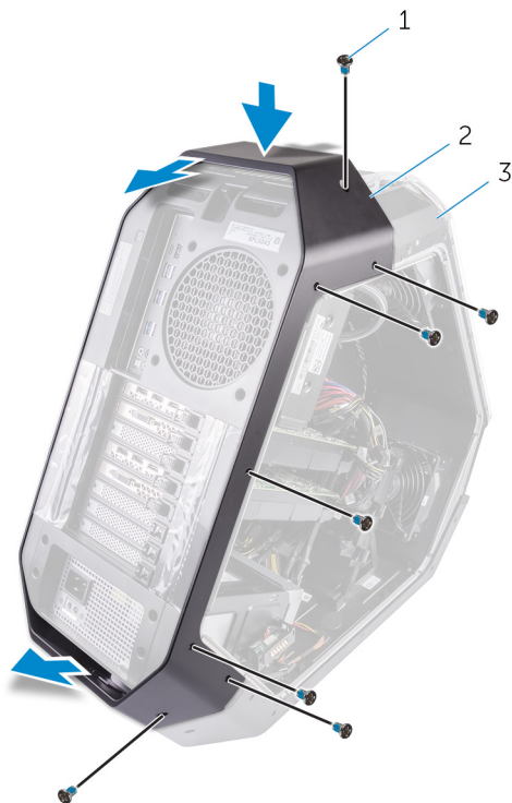
Kuva 53. Takaosan kantokahvan irrottaminen
