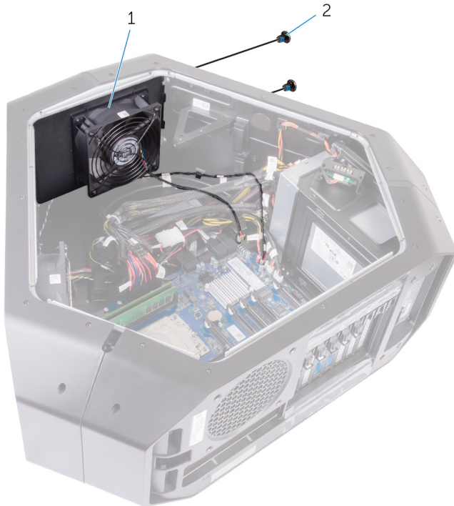
Kuva 41. PCI:n tuulettimen irrottaminen
